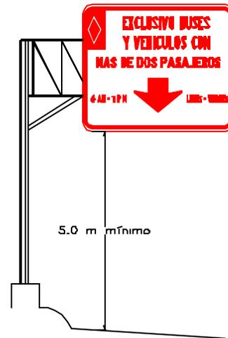
2.9.D Señal Reglamentaria Elevada tipo "bandera" con superelevación
