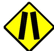
La señal P-5-4 se debe emplear para advertir la reducción en el número de carriles de circulación. Para indicar la proximidad de una reducción peligrosa debido a la existencia de un puente, viaducto u otra estructura, se utilizará la señal P-5-5. En carreteras de doble vía debe usarse siempre que el ancho del pavimento de la estructura sea inferior a 5.50 m. La dimensión se redondeará a los 10 cm más cercanos.
