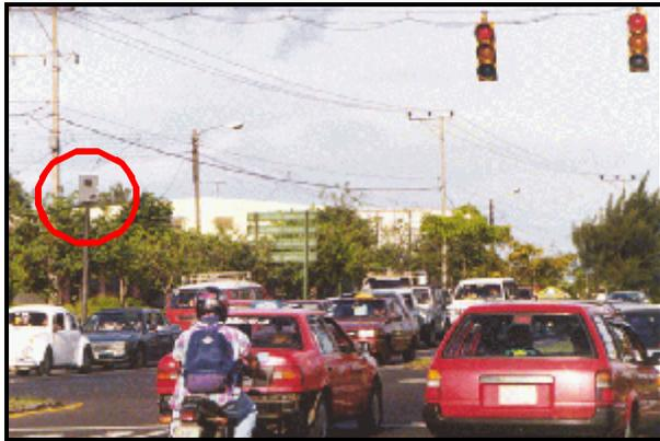
**Figura 2.34** Dispositivo de vigilancia automática de respeto luz roja del semáforo mediante cámara fotográfica, Costa Rica
