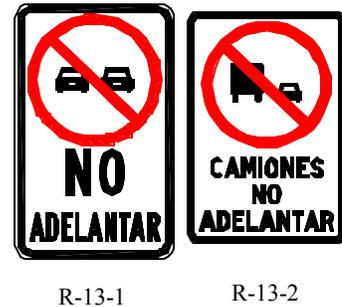
Normalmente se colocarán del lado derecho de la vía, pero como el conductor que trata de adelantar a otro vehículo tiene poca visibilidad a la derecha es conveniente colocar una señal adicional de este mismo tipo del lado izquierdo de la carretera. Estas señales se deben complementar con las marcas sobre el pavimento correspondientes, según se detalla en la sección 3.2.3.
