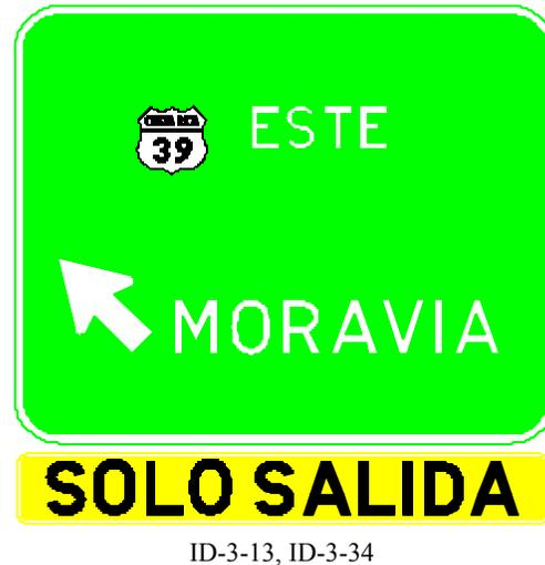
Para el caso específico de rotondas, en este Manual se establece utilizar las señales de las series ID-3-7 e ID-3-8, ID-3-11 e ID-3-12 y las placas ID-3-35, ID-3-36 para canalizar el tránsito en los accesos. De este modo, se indicará la ubicación de los vehículos en los carriles de acceso utilizando una señal de fondo verde con dibujos en blanco y en su parte inferior, en recuadro amarillo, la indicación de la ubicación del carril que se debe respetar.
