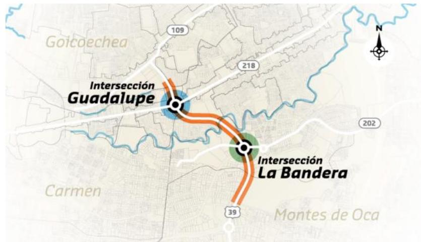
La alternativa adoptada para ambas soluciones a desnivel es la de paso inferior del tronco de la Ruta Nacional No. 39 bajo estas intersecciones (Rotonda La Bandera e Intersección Guadalupe), manteniéndose a nivel actual, las conexiones con la vías transversales que acceden a ellas.
